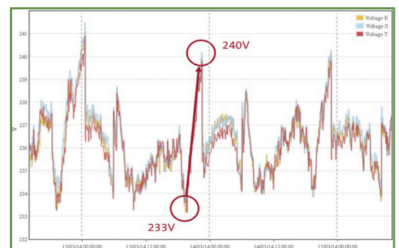
Abb.2: Spannungsschwankungen zwischen 233V - 240V
